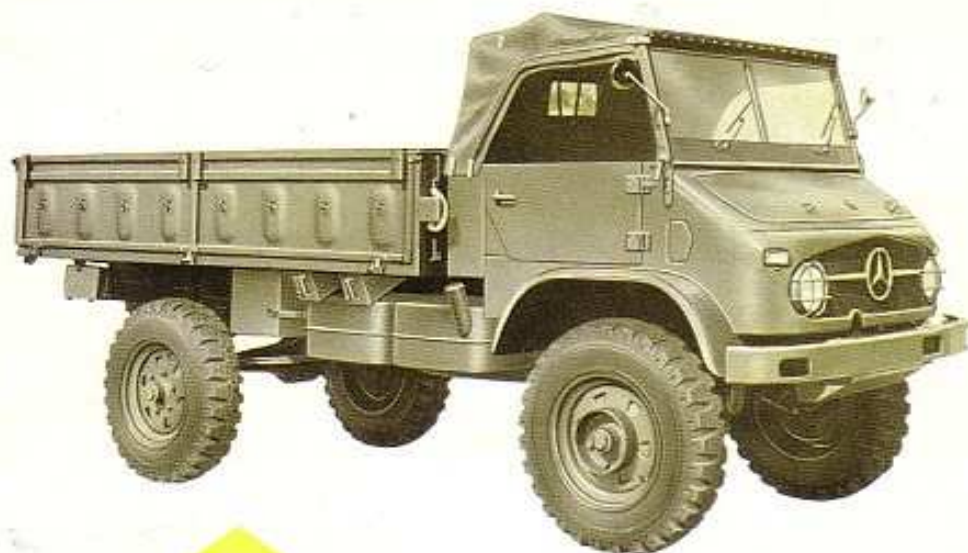
UNIMOG S avec cabine à capote pliable
