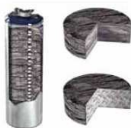
Colis métallique contenant plusieurs galettes de déchets MA-VL
