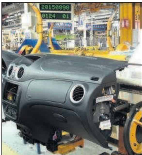
▲ **ETAPE 2, L'HABILLAGE.** Là, on enlève les portes pour les garnir, et on habille l'intérieur des voitures (en y installant tableau de bord, sièges, etc.).
