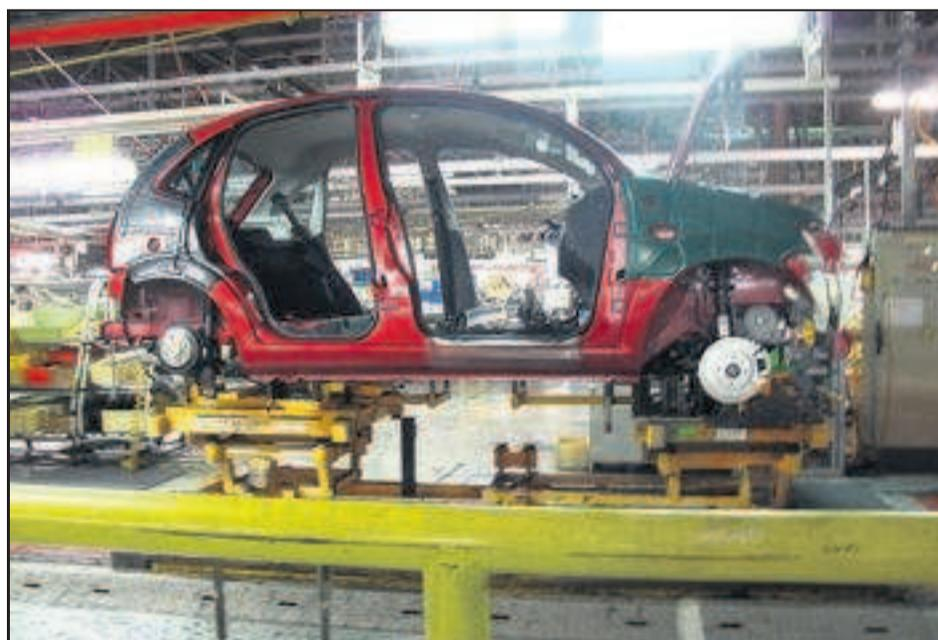
▲ **ETAPE 3, LE COIFFAGE.** A l'atelier de montage, la caisse est posée sur une luge sur laquelle sont disposés ce qu'on appelle les organes mécaniques de la voiture (moteur, suspensions, boîte de vitesses, échappement).
