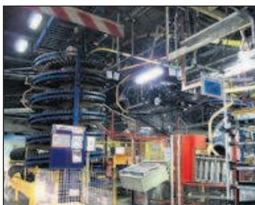
◀ **ETAPE 4.** Après la pose du moteur, on fixe les roues. Elles descendent par le colimaçon bleu pour être installées sur les voitures.
