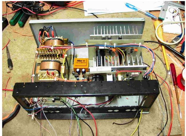
Montage façade arrière et câblage de celle-ci
