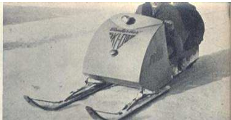
Bombardier, constructeur du « Muskeg », produit aussi le Ski-Doo, fort répandu aux Etats-Unis et au Canada pour remplacer la voiture inutilisable parfois en hiver, ou pour faire fonction de véhicule de service dans les stations.
