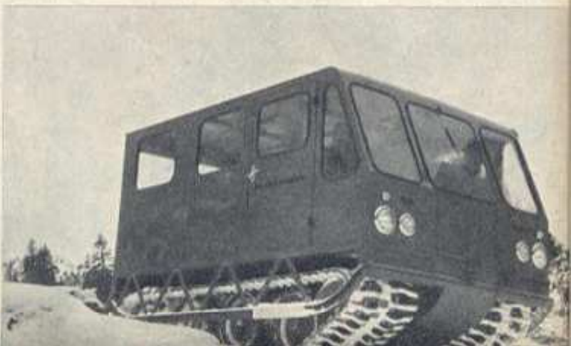
Le « Muskeg » fait office d'autocar, en Suisse, sur les chantiers de haute montagne, là où aucun autre engin ne pourrait passer.
