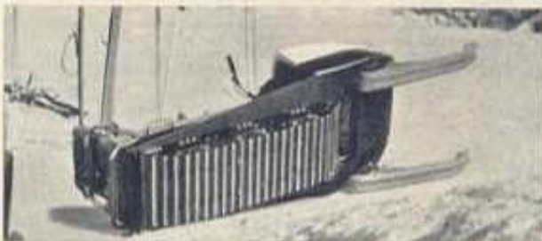
Le « Muskeg » Bombardier-Rolba M.63, modèle standard ne se différencie des autres que par l'emplacement du moteur et le nombre des roues.
