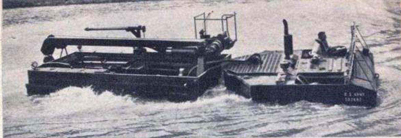
LE WRECKER GOER glisse sur les eaux en crue quelque part au Vietnam. Il peut se déplacer à 5 km.-h. sur l'eau.
