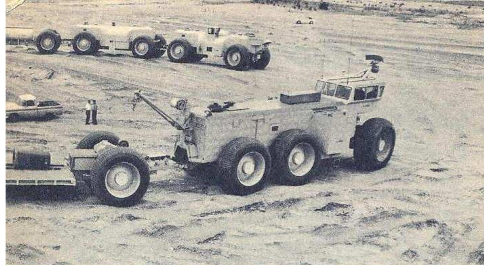
d'une visibilité parfaite dans toutes les directions. C'est à peine si l'on entend un léger sifflement lorsqu'une commande électrique braque les roues avant.
