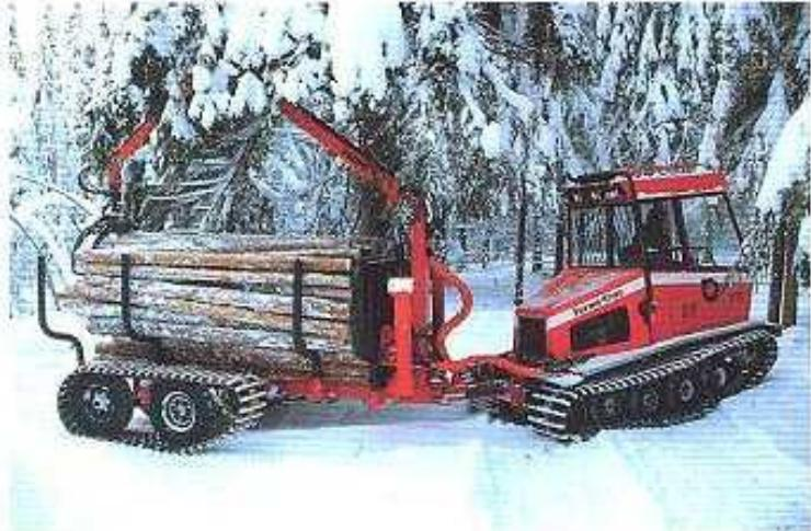
Le **FARMI-TRAC** a une transmission hydrostatique. Les chenilles viennent aider l'unité de traction. La remorque peut également être équipée, en option, d'une traction hydrostatique à chenilles.
