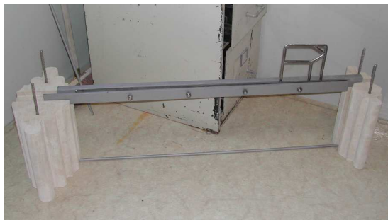
Maquette du principe de renforcement des chaînages
