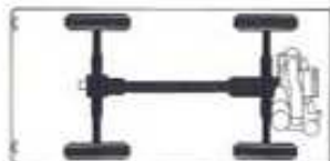
En terrain très accidenté : commande de toutes les roues et blocage du différentiel avant et arrière
