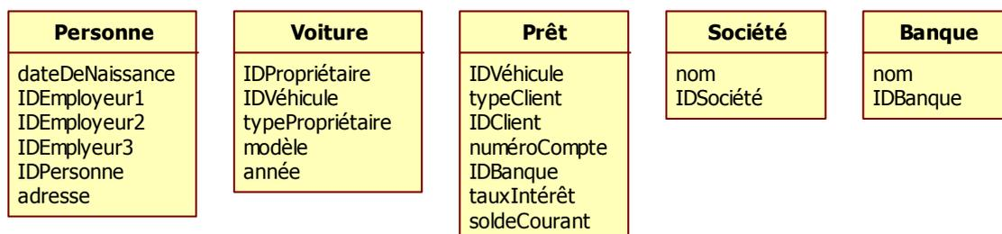
Représentez les liaisons vers d'autres objets comme des références est une façon incorrecte de construire un modèle. Tracez un diagramme de classes dans lequel les ID sont remplacés par des relations. On peut ajouter une ou plusieurs nouvelles classes.
