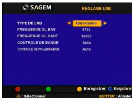
Ce menu est destiné à configurer le LNB : Généralement, les LNB récents sont de type « Universelle », et ne nécessite aucun réglage.
