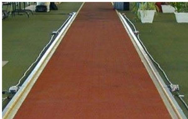
**Figure 3: Système optojump permettant d'observer les temps de contact, de vol et la vitesse à chacun des appuis de course.**
