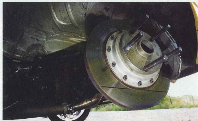
Les disques avant et arrière (photo) de taille différente sont une mauvaise solution pour corriger le déséquilibre du freinage.
